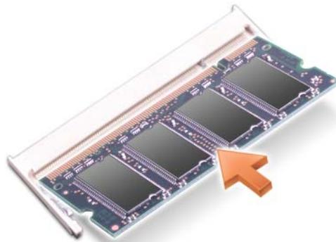
Pour ajouter ou remplacer un module de mémoire dans le connecteur DIMM B :
