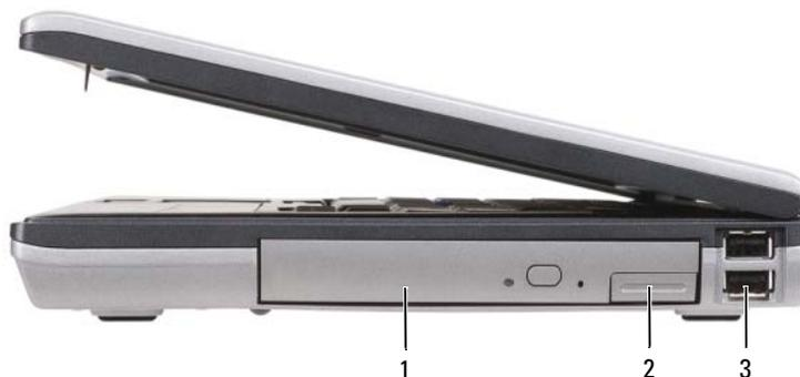
1 baies pour disques    2 loquet de fermeture de la baie de batterie    3 connecteurs USB (2)
