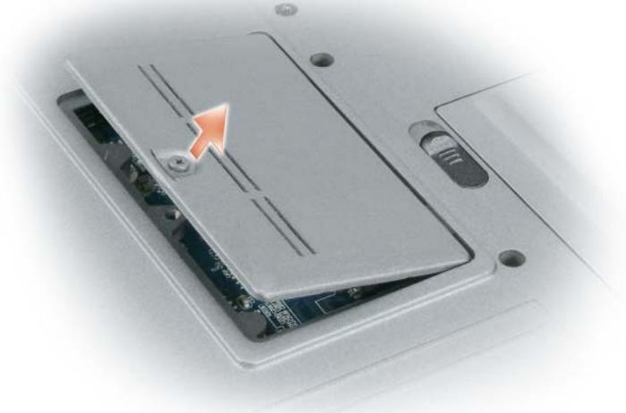
**CACHE DU MODULE DE MÉMOIRE** — Recouvre le compartiment du connecteur du deuxième module de mémoire (DIMM B) (voir "Mémoire" à la page 152).
