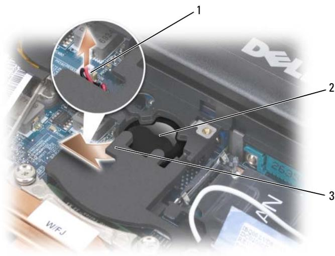
1 connecteur de la pile bouton    2 pile bouton    3 mylar
