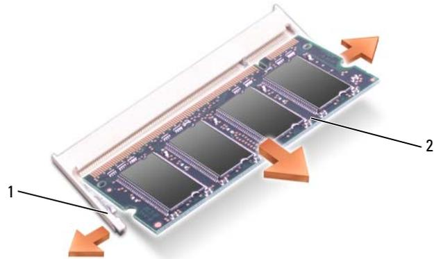
1 clips de fixation (2 par connecteur) 2 module de mémoire
